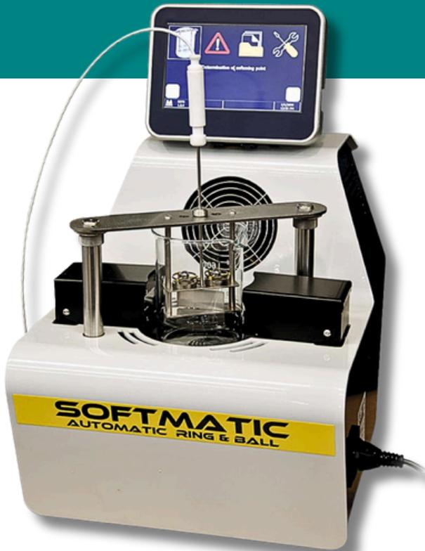
Machine entièrement automatique et conçu pour fournir des mesures rapides, précises et reproductibles du point de ramollissement des asphaltes, bitumes et goudrons.
