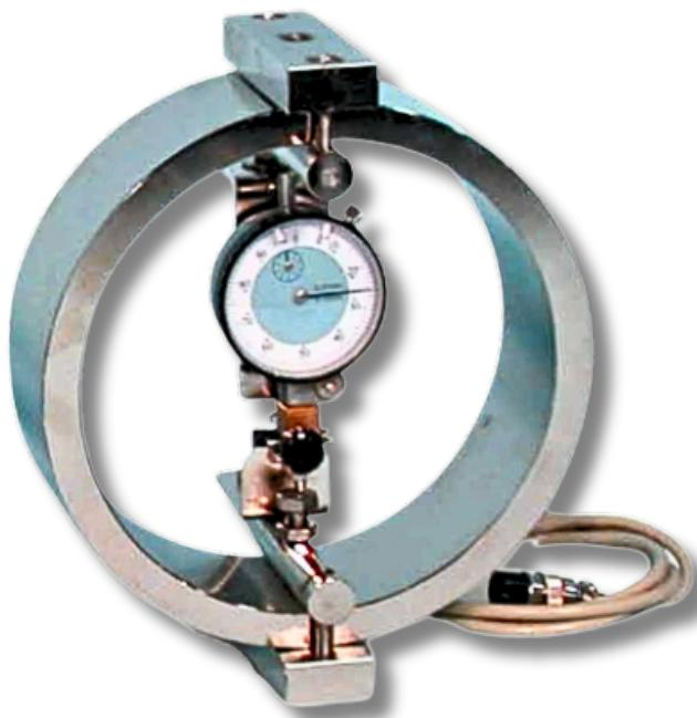
**Utilisé pour mesurer la compression de charge appliquée par la machine d'essai.**
