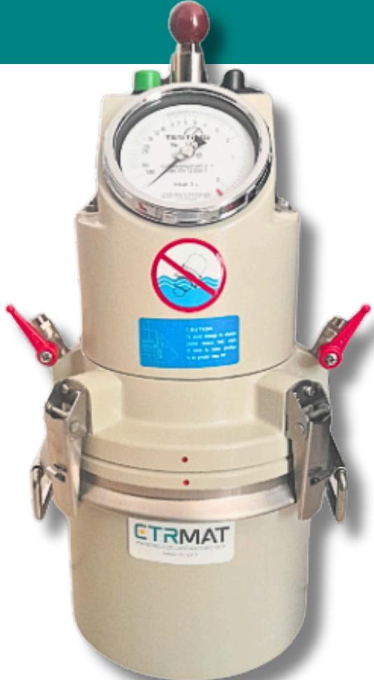
Aéromètre à béton destiné à déterminer la quantité d'air occlus dans le béton frais - pour mesurer la teneur en vide d'air dans le béton frais en affichant directement cette teneur en pourcentage sur un manomètre.
