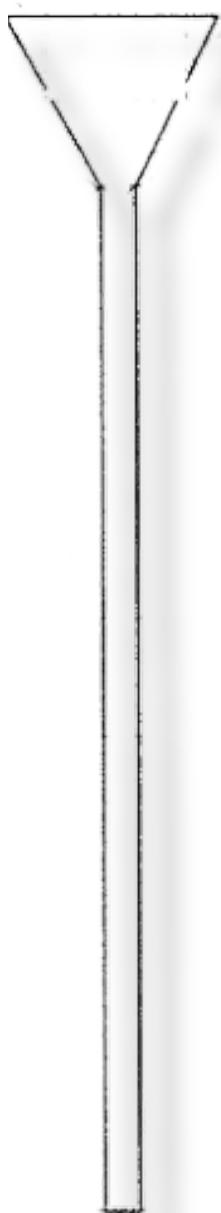
**Entonnoir en verre avec sortie en biseau utilisé pour verser le matériau dans le Voluménomètre le Chatelier.**
