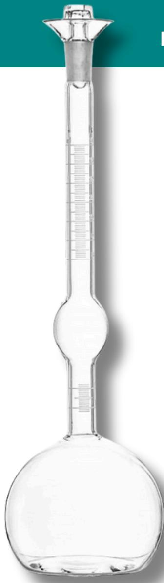
Le Voluménomètre Le Chatelier est utilisé pour déterminer la masse volumique (densité relative) du ciment hydraulique, de la chaux et des poudres suivant la norme EN 196-6; ASTM C188; AASHTO T133.
