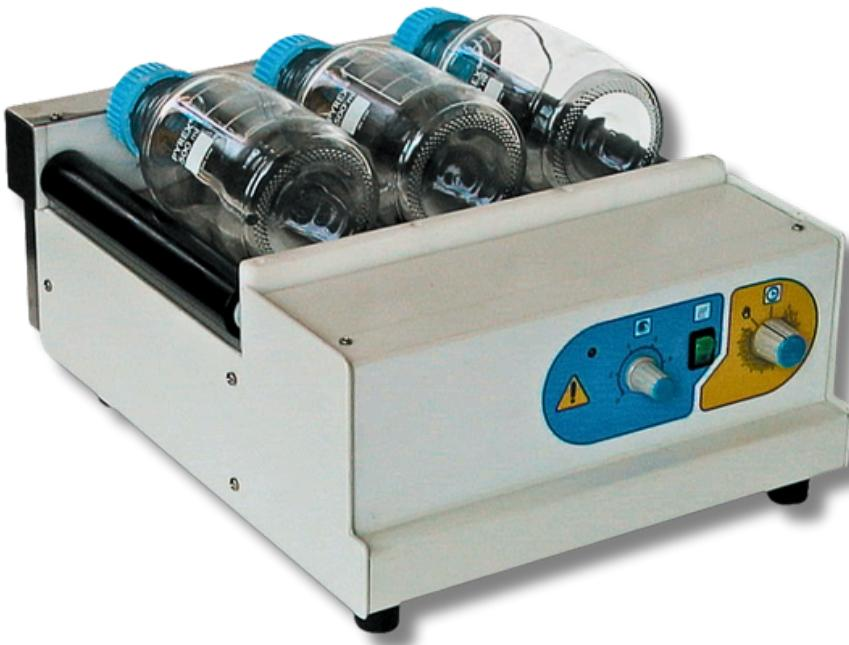
Elle sert à déterminer l'affinité entre les agrégats et le bitume, exprimée par l'enregistrement visuel du degré de couverture des particules d'agrégats minéraux non compactés enrobées de bitume après l'influence de l'action mécanique de l'agitation en présence d'eau.
