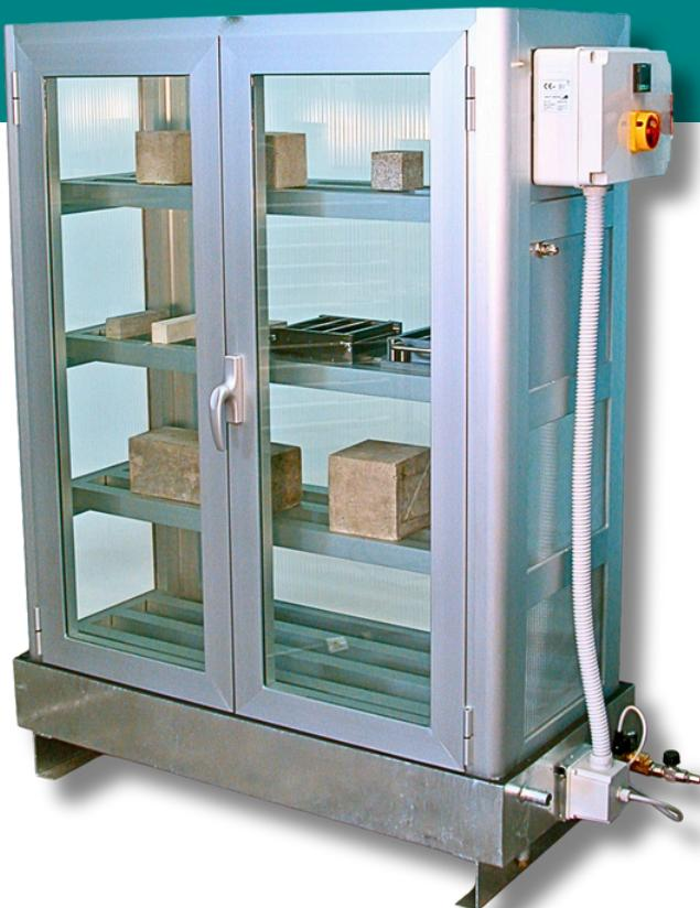
Armoire en aluminium et polycarbonate destinée au stockage et à la maturation de grandes quantités d'échantillons de mortier, ciment, de béton, etc. dans des conditions de température et d'humidité contrôlées.
