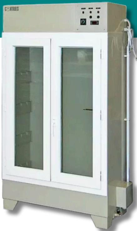
Armoire de conservation destinée à la conservation d'éprouvettes ciment, mortier, chaux et plâtre en laboratoire, pratique et d'utilisation aisée.
