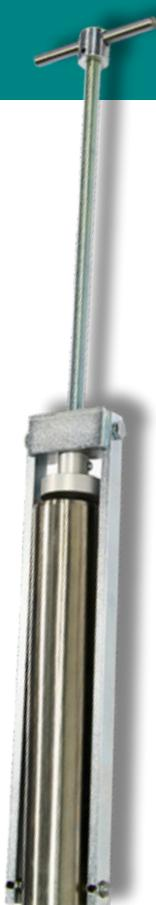
L'équipement d'échantillonnage est utilisé pour prélever des échantillons intacts diamètre 38 mm de sols fins et mous.
