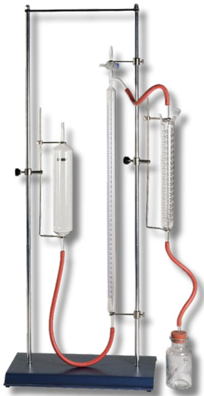
**Teneur en carbonate des granulats - Utilisé pour la détermination du taux de CaCO<sub>3</sub> spécialement dans le calcaire et la marne.**
