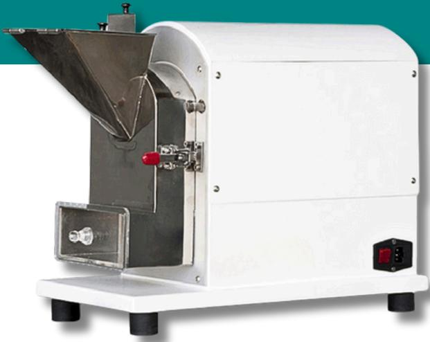
Broyeur à marteaux utilisé pour broyer de petites quantités de produit à des fins d'essais en laboratoire.
