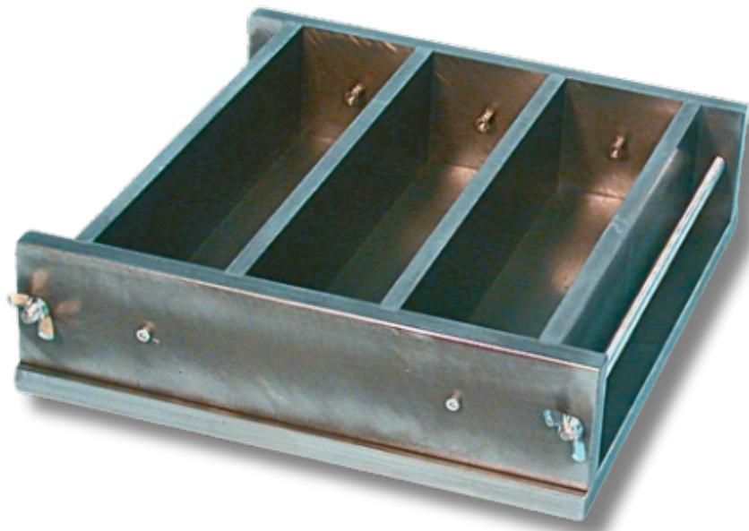
**Moule triple 3 alvéoles pour prismes de ciment mortier utilisé pour préparer les échantillons de mortier destinés aux essais de compression et de flexion.**
