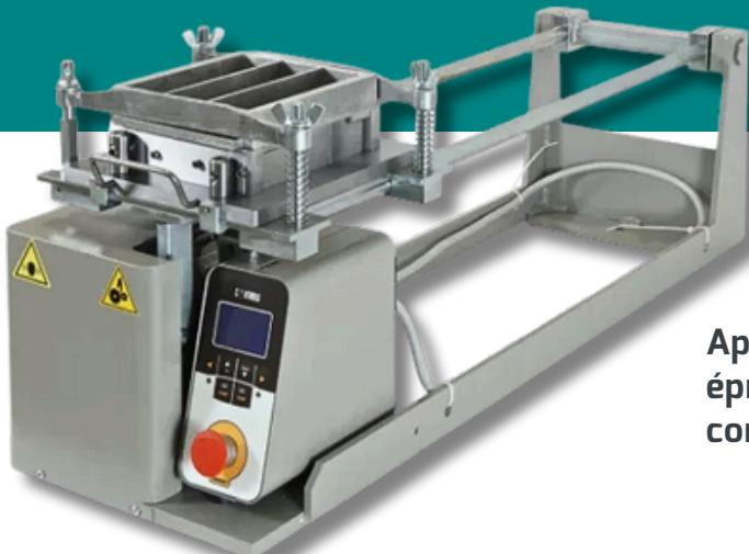
Appareil à chocs pour le serrage des éprouvettes de mortier 40 x 40 x 160 mm conformément aux normes EN et ISO.
