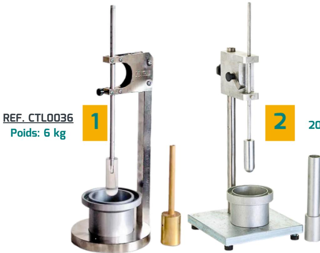
Appareil utilisé pour déterminer la consistance du ciment à maçonner, du mortier ou de la chaux de construction.
