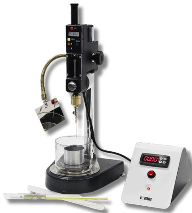
**Utilisé pour mesurer la pénétration conformément aux normes EN 1426, ASTM D5 et AASHTO T49.**
