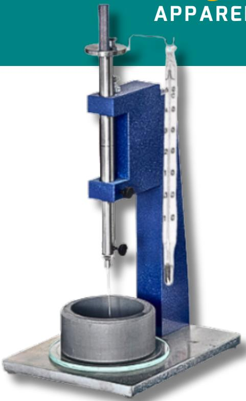
Appareil Vicat manuel pour la détermination du temps de prise des ciments et mortiers.
