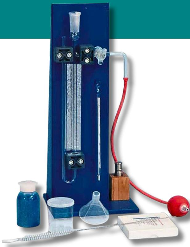
Cet appareil sert à déterminer la finesse du ciment Portland en termes de surface spécifique exprimée en surface totale en centimètres carrés par gramme de ciment.
