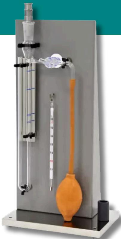
Cet appareil sert à déterminer la taille des particules du ciment Portland, de la chaux et d'autres poudres fines similaires exprimée en termes de surface spécifique
