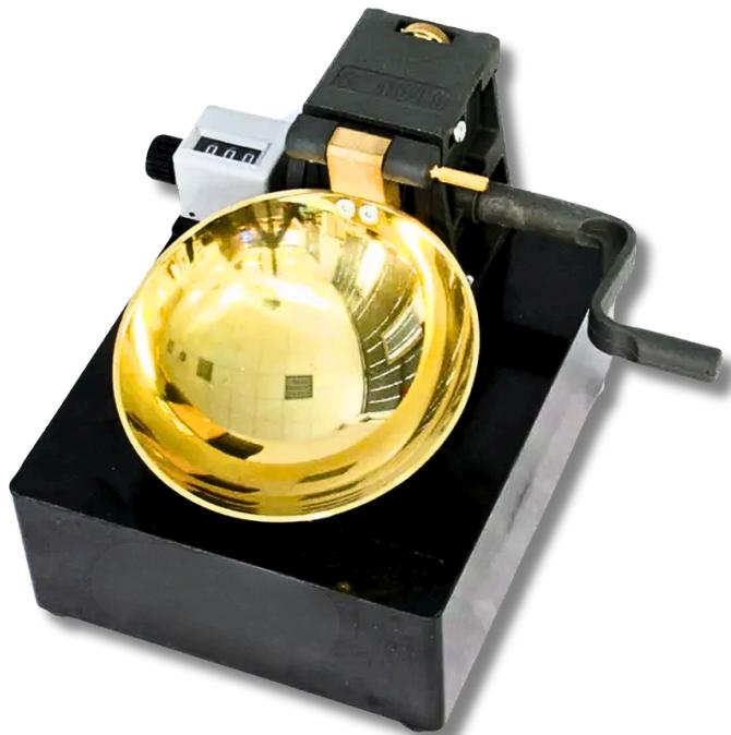
Appareil de Casagrande pour limite d'Atterberg, avec fonctionnement manuel utilisé pour déterminer le taux d'humidité à partir duquel les sols argileux passent d'un état plastique à un état liquide.
