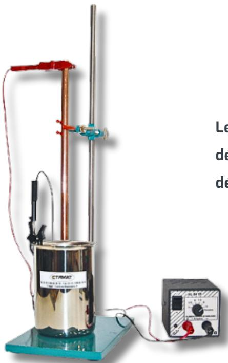
Le test est basé sur la mesure du tassement pour déterminer la stabilité au stockage des émulsions par décantation. conformément à la norme NF T66-022.
