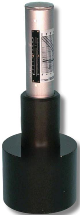
**Utilisé pour la vérification de l'étalonnage des marteaux d'essai pour béton. Fabriqué en alliage d'acier spécial.**
