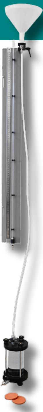
**L'appareil combiné à charge constante ou variable est un système de base permettant d'utiliser les méthodes à charge constante ou variable pour déterminer la perméabilité du sol.**
