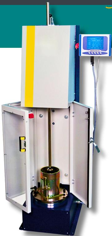
Utilisé pour compacter les éprouvettes Proctor et CBR en assurant un degré de compactage extrêmement uniforme et par conséquent des résultats fiables et reproductibles.
