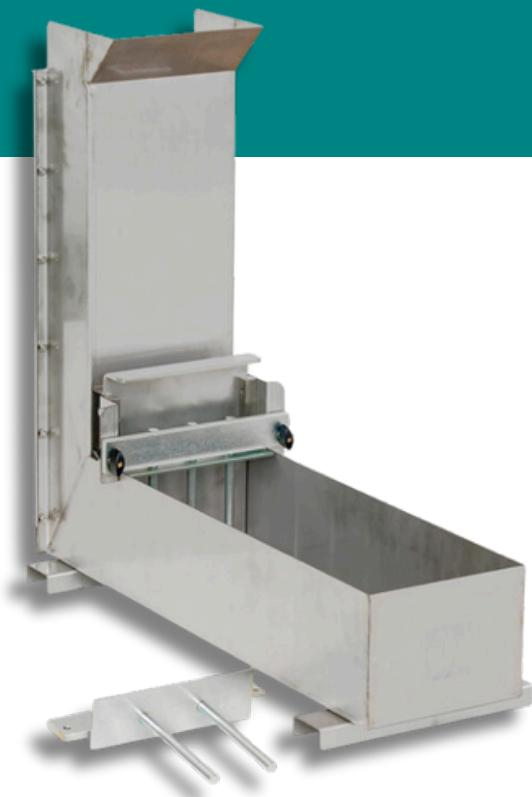
Appareillage destiné à la détermination de l'écoulement en milieu confiné, du taux de remplissage, à l'aide de l'essai à la boîte en L, pour le béton auto-plaçant.
