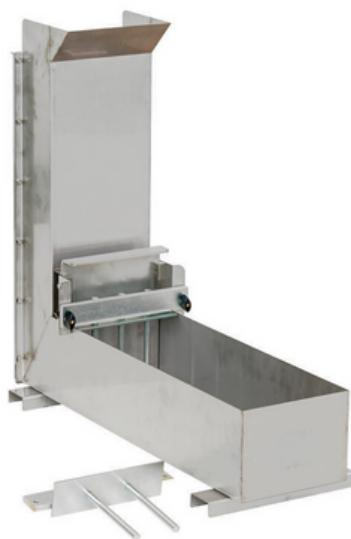
Appareillage destiné à la détermination de l'écoulement en milieu confiné, du taux de remplissage, à l'aide de l'essai à la boîte en L, pour le béton auto-plaçant.
