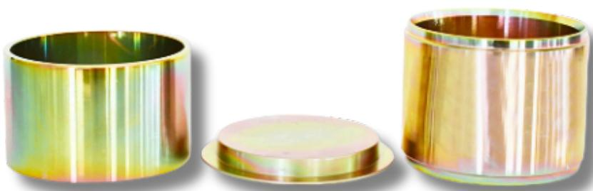
**Moule Marshall complet avec corps, hausse et embase utilisé pour compacter un enrobé et en déterminer la relation entre sa masse volumique apparente ou son pourcentage de vides et l'énergie de compactage qui lui est appliquée à l'aide de machines de compactage par damage, Méthodes d'essai pour mélange hydrocarboné à chaud - Partie 10**
