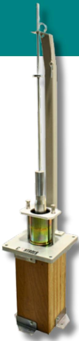
**Normes ASTM D1559: Méthode normalisée pour la préparation d'échantillons de mélanges bitumineux à l'aide de l'appareil Marshall**
