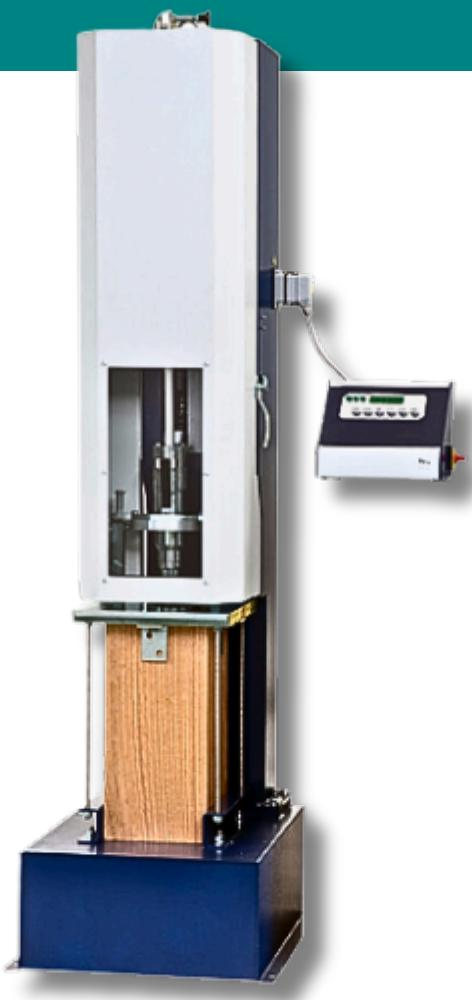
Compacteur automatique Marshall norme EN conçu pour les laboratoires effectuant des contrôles de qualité, des recherches et des essais sur l'asphalte selon la norme EN, offrant un compactage précis, sûr et efficace des échantillons d'asphalte et échantillons bitumineux. Normes NF EN 12697-10 / NF EN 12697-30
