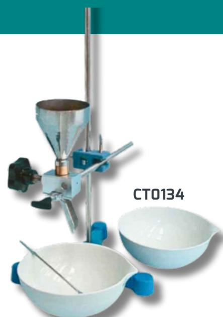
La valeur de rupture du kit de test des émulsions cationiques correspond à la quantité de charge nécessaire pour coaguler une émulsion bitumineuse.
