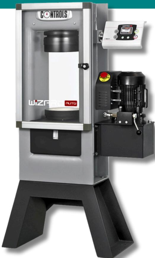
**Machine de compression automatique, Capacité 2000 kN pour cylindres jusqu'à 160x320 mm et cubes max. 150 mm**
