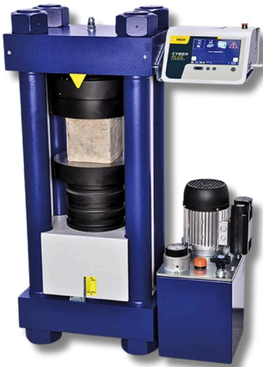
Machine de compression automatique, Capacité 2000 kN pour cylindres jusqu'à 160x320 mm et cubes max. 150 mm
