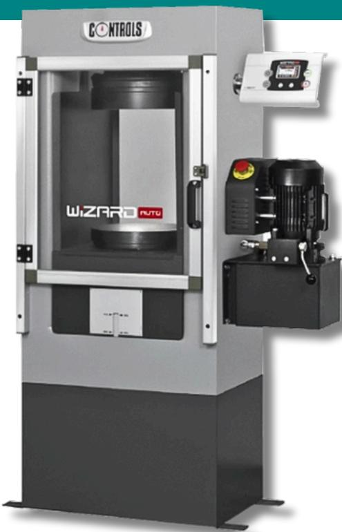
Machine de compression haute résistance Capacité 2000 kN pour BHP et bétons classiques - Pour les cubes 10, 15, 20 xm, 10×20 cm et cylindres 15×30 et 16×32 cm
