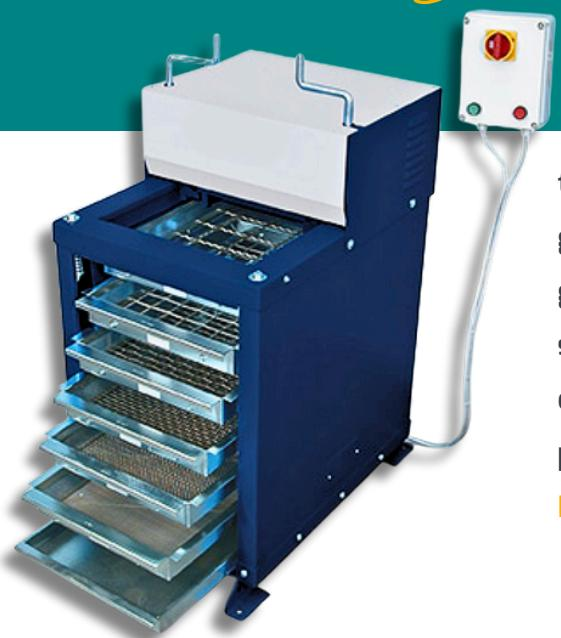
tamiseuse à haute capacité idéale pour le tamisage de grandes capacités d'échantillons de pierre, sable, gravier, minéraux, scories ou autres. Capable d'effectuer simultanément de 2 à 6 séparations, l'unité vibrante comporte un châssis avec des espaces où sont positionnés et maintenus les cadres tamisants.
