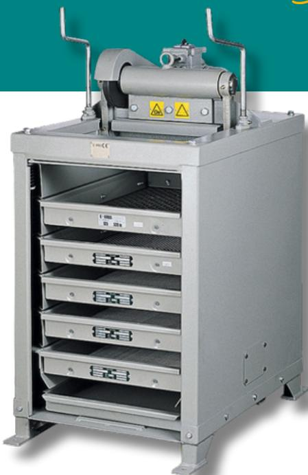
Tamiseuse à haute capacité idéale pour le tamisage de grandes capacités d'échantillons de pierre, sable, gravier, minéraux, scories ou autres. Capable d'effectuer simultanément de 2 à 6 séparations, l'unité vibrante comporte un châssis avec des espaces où sont positionnés et maintenus les cadres tamisants.
