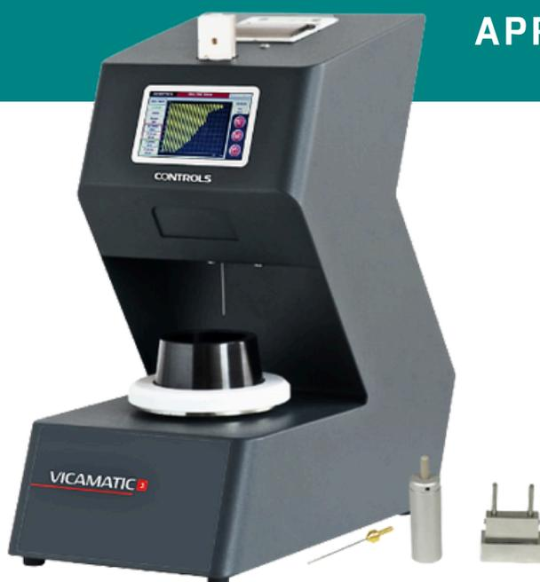
Appareil Vicat automatique pour temps de prise sur ciment/mortier/ plâtre équipé du dispositif de nettoyage d'aiguille.
