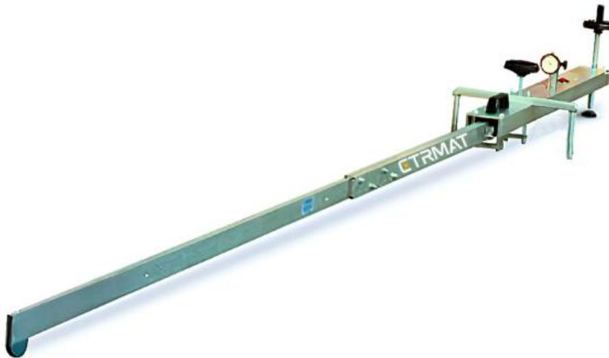
Poutre de Benkelman pour mesurer la déflexion d'une chaussée sous le poids d'un essieu de poids lourd, Norme NF P 98-200-2 et LCPC
