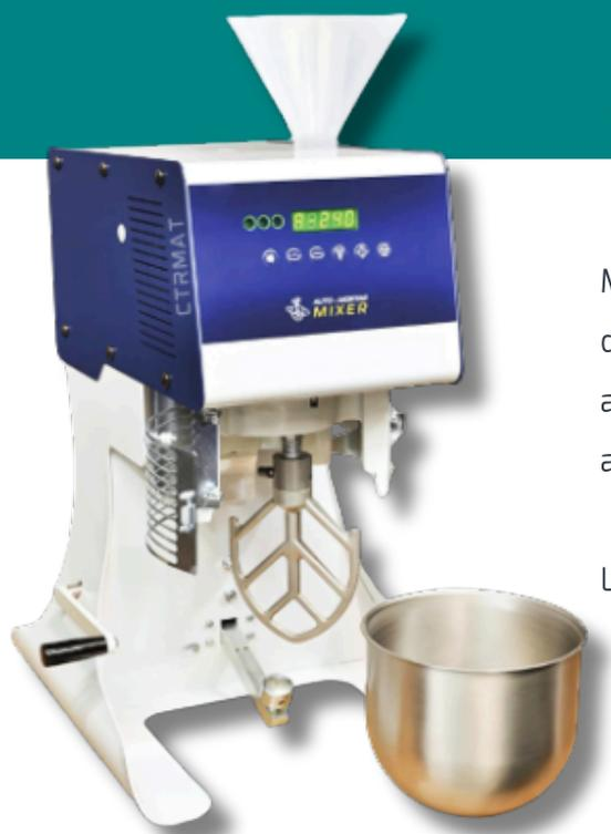
Malaxeur conçu pour le mélange efficace de pâtes de ciment et de mortiers, avec quatre séquences automatiques de cycle de mélange, conformément aux spécifications EN 196-1, EN 196-3 et EN 480-1.
