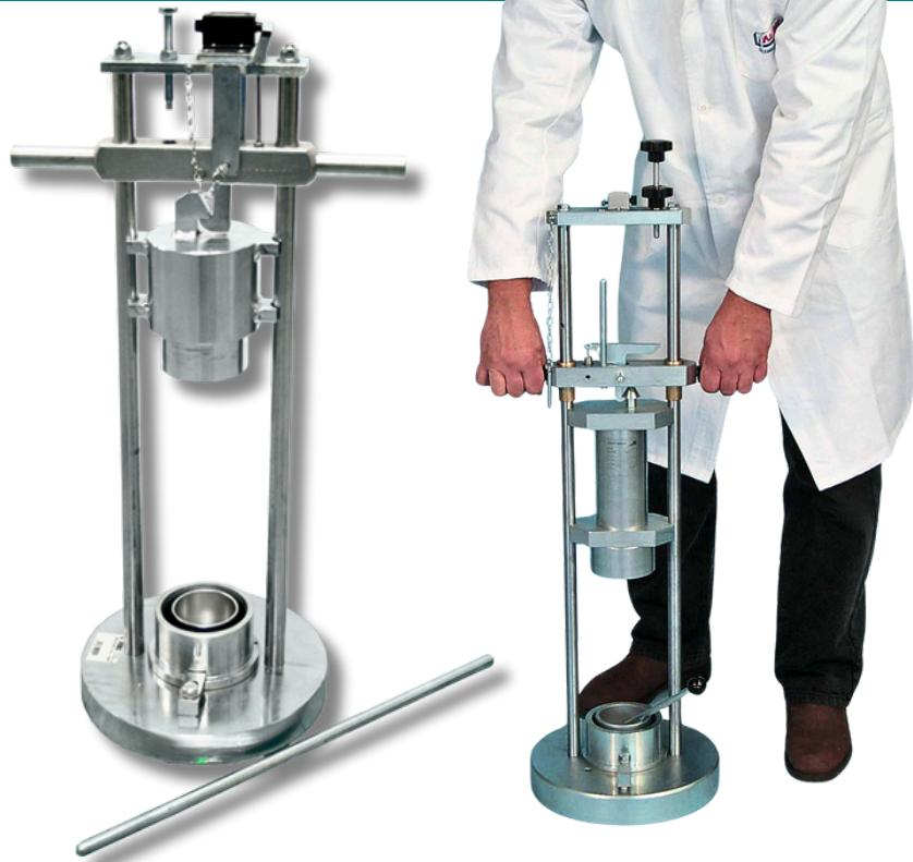
Appareillage pour essai de fragmentation dynamique utilisé pour déterminer la résistance aux chocs des agrégats et les sélectionner pour une application donnée.
