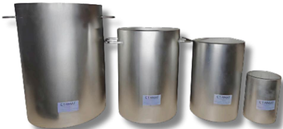
Réciipient cylindrique de mesure destiné à la détermination des masses volumiques,
