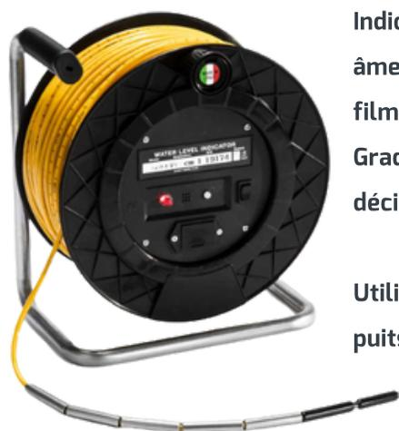
Indicateur de niveau d'eau avec câble rond, quatre fils de cuivre, âme en kevlar et film de protection
